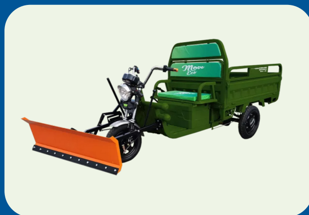
Abbildung: Elektro-Cargo-Lastendreirad mit Winterdienst- Ausrüstung
